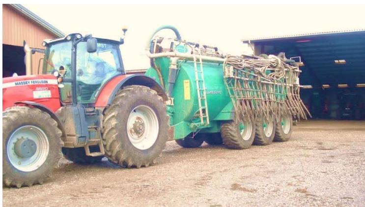
Figura 45. Cisterna com dispositivo de acidificação de chorume no momento de aplicação ao solo. A adição do ácido ocorre dispositivo que está montado no topo da cisterna (câmara de acidificação). O ácido é transportado num tanque protegido que está montado na frente do trator (fotografia encastrada no canto inferior direito)
