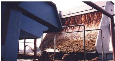
Figura 21. Separador de tela estática inclinada
